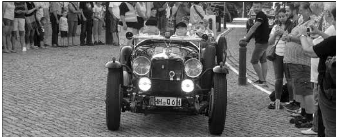
Riley TT Sprite Baujahr 1935 1496 Kubikzentimeter Hubraum, 60 PS Leistung
