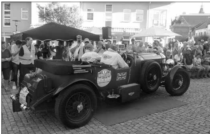
Das älteste Fahrzeug: Bentley 8 Litre Le Mans Open Tourer, Baujahr 1931, 7983 Kubikzentimeter Hubraum (größter Hubraum aller teilnehmenden Fahrzeuge), 220 PS Leistung
