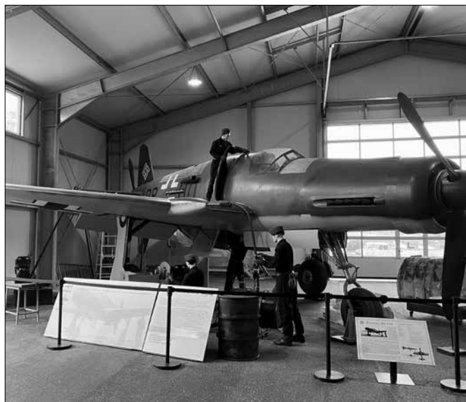
Dornier Do 335 mit Zug- und Druckantrieb, realisiert mit zwei 12-Zylinder-Reihenmotoren Daimler Benz 603 A-2.
